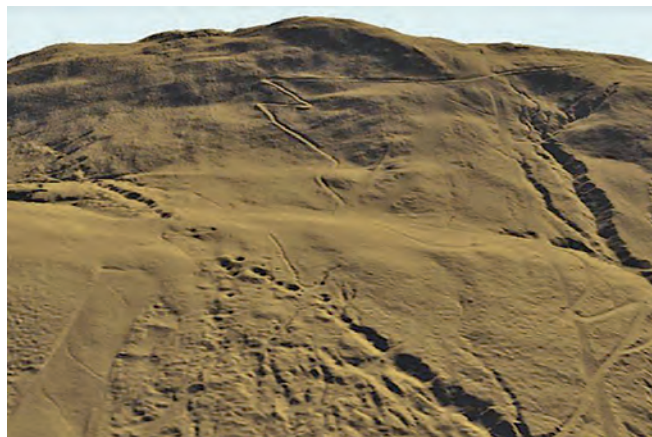
Abb. 51: Mitterberg-Hauptgang/Troiboden: Lidar-Scan (Airborne-Laserscanning) des Hauptganges mit Pingenzug und Haldenbereichen (links); Nassaufbereitungskasten des 13./12. Jh. v. Chr. im Aufbereitungsareal des Troibodens (rechts), Foto: Th. Stöllner, RUB/DBM.
