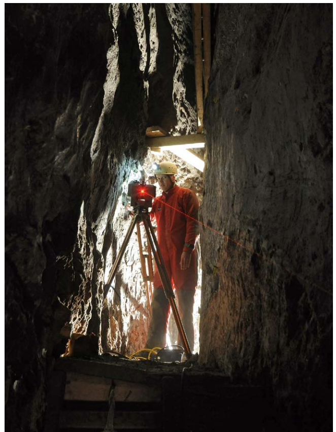
Abb. 79: Vermessungsarbeiten für die Passpunktaufnahme am Grabungsprofil zur Erstellung eines Fotoplanes im Georgenberg durch Dipl.Ing. G. Steffens, DBM; Foto: Th. Stöllner, RUB/DBM.
