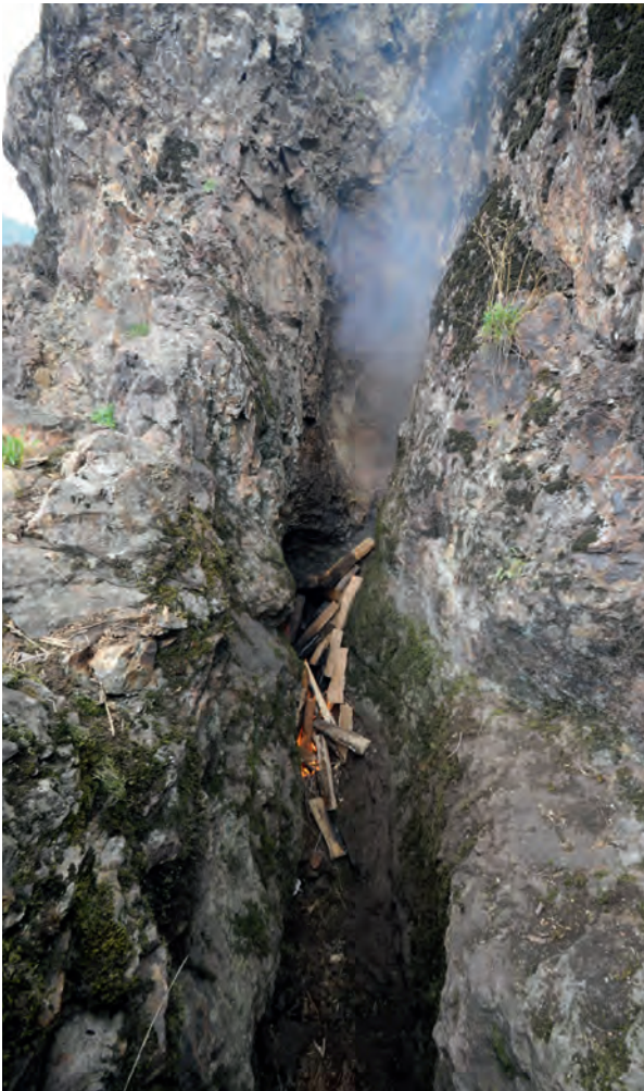
Abb. 86: Sakdrissi, Feuersetzen am südlichen Stoß von Grube B3; gut ist der Kamineffekt beim Feuersetzen an hohen Feldorten (sog. „Brust“) zu erkennen (Foto: DBM/RUB, Th. Stöllner).
