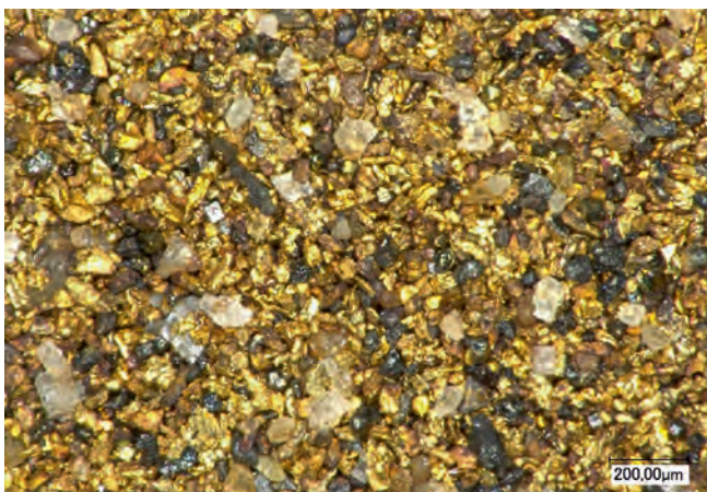
Abb. 131: Sakdrissi, GeorgienKonzentrat von Goldflittern, die aus dem Bergwerk von Sakdrissi aus ca. 150 kg Erz ausgewaschen wurden. Dieses Konzentrat ist ein klarer Beleg dafür, dass Sakdrissi ein prähistorisches Bergwerk gewesen ist. (Foto: DBM, Moritz Jansen).
