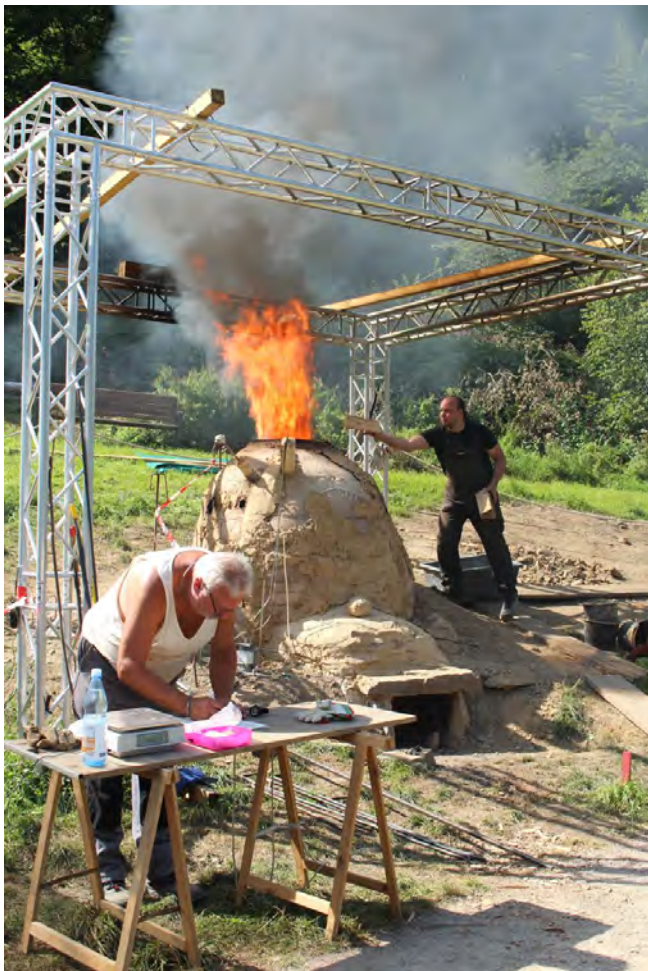
Abb. 149 und Abb. 150: Der Ofen während des Verhüttungsversuchs; Foto: M. Zeiler, LWL
