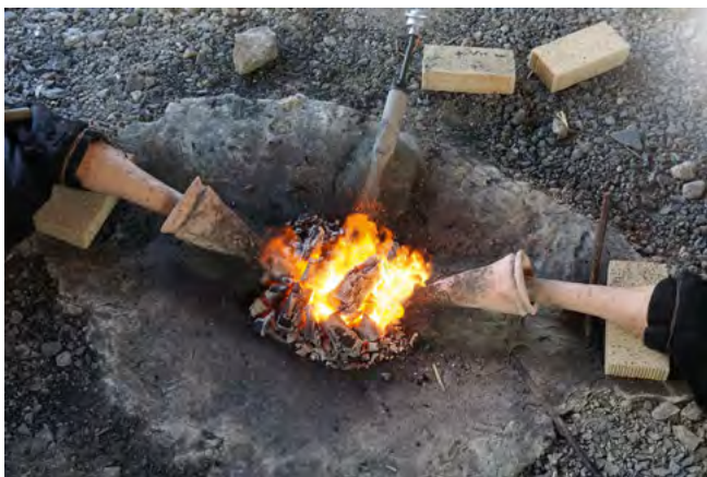
Abb. 200: Gebauter Ofen mit getöpferten Blasebalg, Düsen als Ansatz für die Blasebälge und 4 Thermoelemente, die in verschiedenen Höhenniveaus die Temperaturverhältnisse des Ofens dokumentieren sollen. Ofenbesichtigung durch Th. Rose, wissenschaftlicher Mitarbeiter des Projektes (Foto im Besitz des Projektes).
