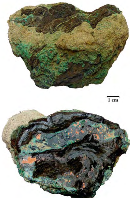
Abb. 84: Sulfidhaltiges Kupfererz aus der Gemarkung Hidirbağ, oben ungesägt, unten Schnittfläche.
