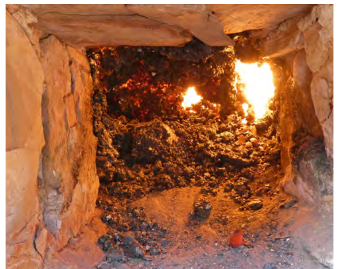
Abb. 143: Foto in den Schürkanal und das Innere des Ofens, wo die schon gebildete Luppe ausgeräumt werden kann, Foto: DBM/LWL, J. Garner.
