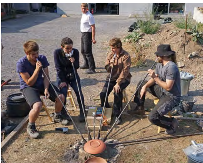
Abb. 201: Verhüttung in der Grube, Luftzufuhr durch Blasrohrdüsen mit lederhart getrockneten Keramikspitzen (Foto im Besitz des Projektes).
