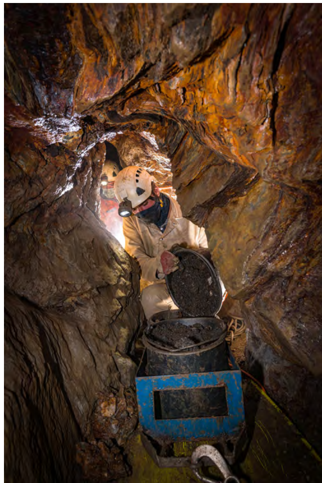
Abb. 167: Förderarbeiten im Firstbau des östlichen Gangtrumms östlich des „Petersdomes“ bei Lfm. 4685 (Foto: DBM, P. Thomas).
