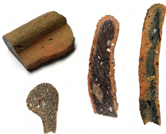
Abb. 135: Querschnitte (rechts) und Dünnschliff (links unten) nuraghischer Keramik (Foto: RUB, M. Usadel).
