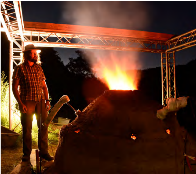
Abb. 164: Verhüttungsexperiment im Freilichtmuseum Hagen (Foto: DBM, G. Steffens).
